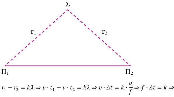
$$r_1 - r_2 = k\lambda \Rightarrow v \cdot t_1 - v \cdot t_2 = k\lambda \Rightarrow v \cdot \Delta t = k \cdot \frac{v}{f} \Rightarrow f \cdot \Delta t = k \Rightarrow$$
